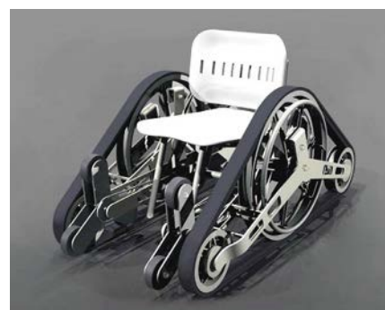
Sl. 72 - Koncept invalidskih kolica koja bi trebala omogućiti penjanje uz i silaženje niz stepenice
