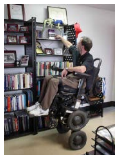
Sl. 89 i sl. 90 - Mogućnosti iBOT-a: kretanje stepenicama i uspravljanje
