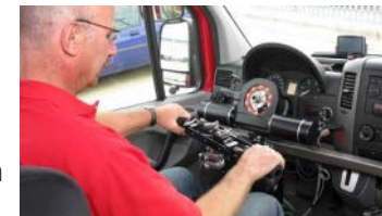
Sl. 80 - Korman sličan motociklističkom ugrađen umjesto volana
