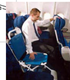
Sl. 197 i sl. 198 - Način korištenja kolica za ukrcavanje nepokretnih lica u avion
