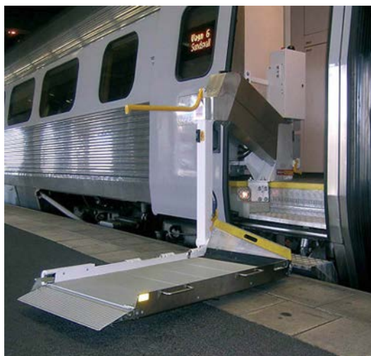
Sl. 193 - Podizna platforma za unošenje invalidskih kolica u vagon
