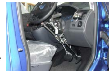
Sl. 83 - Komande gasa, kvačila i kočnice izvedene u vidu poluga uz stub volana
