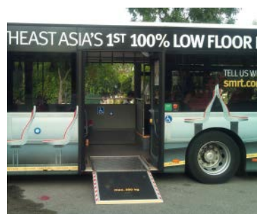
Sl. 166 - Niskopodni autobus sa izvlačećom platformom uz srednja vrata
