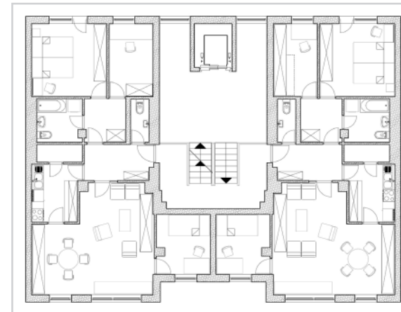
Sl. 291 - Ulazi u stanove na punoj etaži, a u lift na međuetazi
