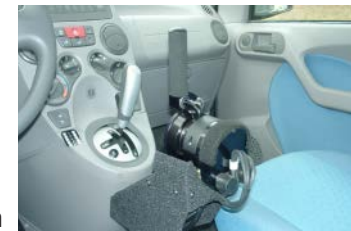
Sl. 81 - Joystick ugrađen (alternativno) uz volan
