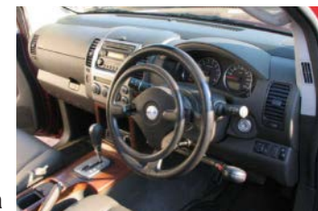
Sl. 82 - Obruč komande gasa iznad obruča volana
