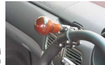
Sl. 79 - Kuglasta ručica ugrađena na volan radi njegovog lakšeg zahvatanja i okretanja
