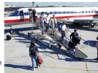
Sl. 204 - Pristup malom avionu upotrebom specijalne mehaničke kosine
