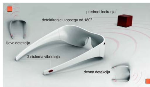
Sl. 342 - Način funkcioniranja ultrazvučnih naočala
