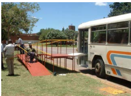
Sl. 184 - Improvizirani pristup za korisnika invalidskih kolica u međugradski autobus u Južnoj Africi
