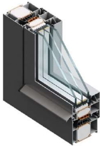
Fotografija 5.9. Vanjski otvor Feal 85Plus , Vanjski okvir je aluminij, moguća obrada u različitim bojama kao i u teksturi koja imitira drvo. U kombinaciji sa staklom od 3 sloja je moguće u zavisnosti od odnosa površine profila i stakla dostići U-vrijednost 0,8 W/m 2 K ili nešto nižu.
