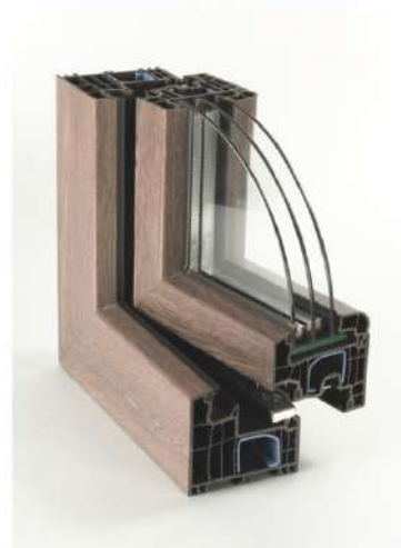
Fotografija 5.11. Vanjski otvor Rehau Geneo , kompozitni materijal ojačan staklenim vlaknima RAU-FIPRO®, koekstrudirani vanjski sloj cijelom duljinom iz visokokvalitetnog RAU-PVC-a za najbolju kvalitetu površine. U-vrijednost je sa ovim sistemom u zavisnosti od kvaliteta stakla i broj staklenih ploha moguće dostići do 0,76 W/m 2 K
