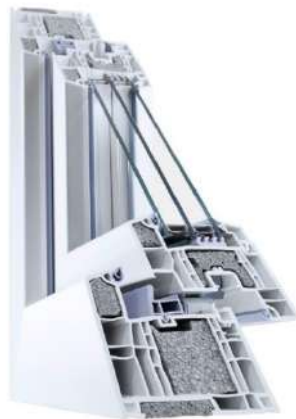
Fotografija 5.12. Vanjski otvor Salamander BluEvolution , The bluEvolution 92 sustav profila ujedinjuje vrhunsku tehnologiju usmjerenu na budućnost s modernim, pragmatičnim dizajnom za novu generaciju prozora svjetske klase. Optimizirani 6-komorni profil s ugradbenom dubinom od 92 mm pruža vrhunsku toplinsku izolaciju i izvrsnu energetska učinkovitost. U kombinaciji s filigranskom vidljivom širinom od samo 118 mm, solarnim dobicima zahvaljujući velikom upadu svjetlosti i ekološkoj održivosti PVC-a koji se može 100% reciklirati, ovo je jedan od Salamanderovih sustava budućnosti. U-vrijednost 0,71 W/m 2 K
