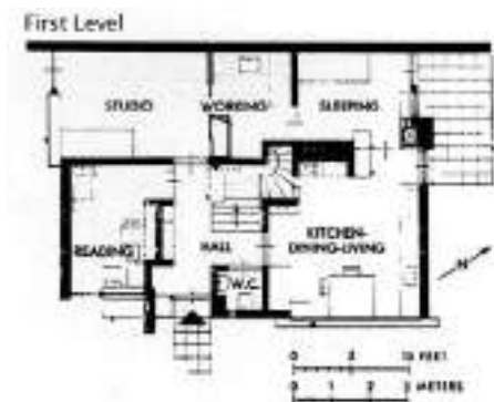
Slika 138. G. Rietveld, kuća Schroeder, Utrecht, 1924. "destrukcija kutije" kojom se forma kuće dinamično otvara na različite načine, a u dispoziciji omogućava fleksibilan tretman prostora
